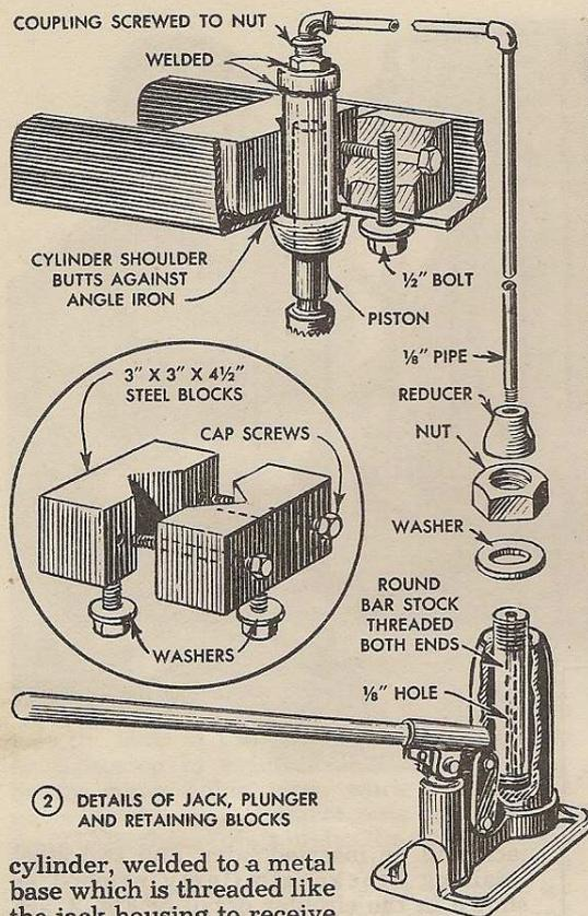
② DETAILS OF JACK, PLUNGER AND RETAINING BLOCKS
